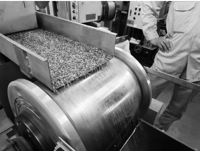
写真6-1 高磁力選別機
