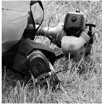
写真9 法面での刈払機による作業時に装着する金属製スパイク
