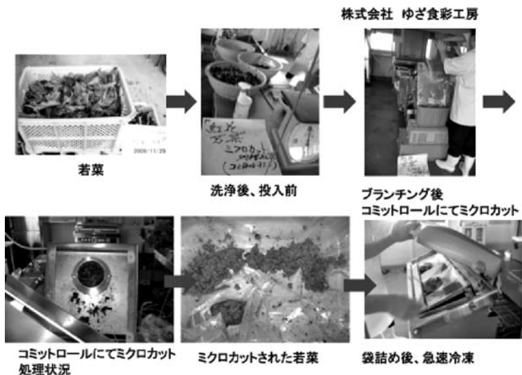
図22 ミクロカットの工程
