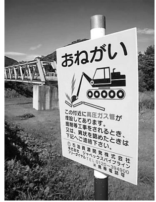
図7：新潟～仙台間のパイプライン。通常地下に敷設し、川を横断するときだけ地上に出る。 (宮城県七ヶ宿町にて、松木兼一郎氏撮影)
