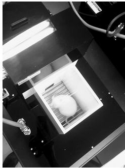
図2 ステップスルー受動回避試験装置 A. 横から見た装置 B. 上からみた明室にいるマウス
