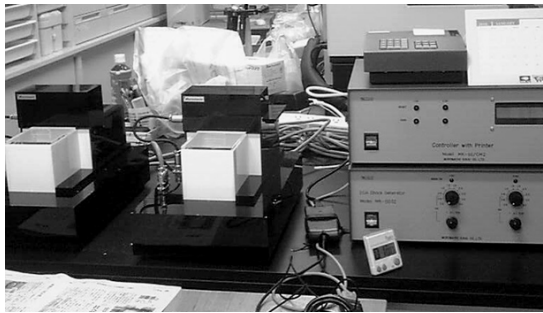
図1 ステップスルー受動回避試験装置の模型図 暗室に入ると足に電気ショックが1秒間、0.5 mA 流れる。
