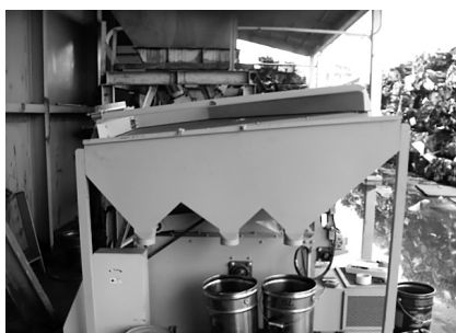
写真1(a) エアテーブル選別機(正面)
